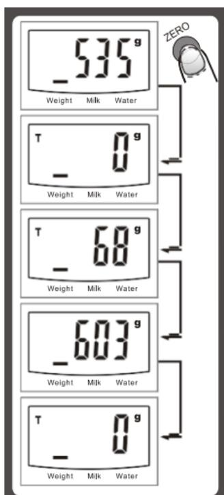
ZERO düğmesine her basıldığında LCD ekranı “—” veya “Og” gösterecektir. “ ”, dengede olmadığını göstermektedir, lütfen bir süre bekleyin. “Og” ile LCD ekranın sol üst köşesindeki bir “TARE” ikonu, DARA işlevinin aktif olduğunu ifade etmektedir. Azami ağırlık kapasitesinden tüm yüklerin toplam ağırlığı düşülmektedir.
